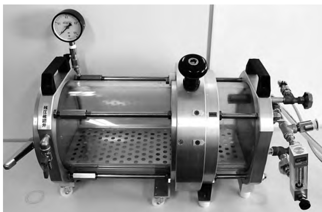
図3：当研究室の動物実験用高気圧酸素治療タンク
